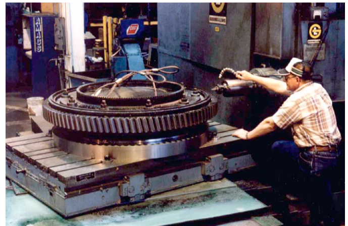
Capacidades integrales de reparación de componentes de vapor y gas, incluido el reacondicionamiento de sellos de H2 de generadores.
