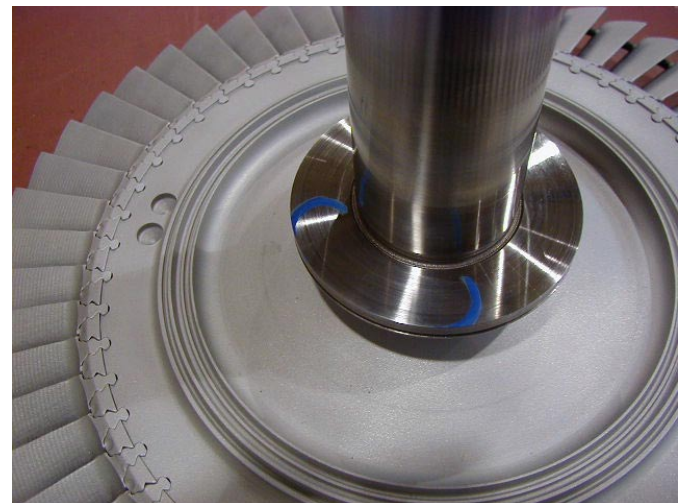
Rotor reparado con paletas refabricadas listo para su instalación
