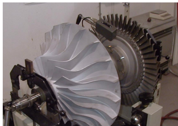
Rotor reparado listo para el balanceo
