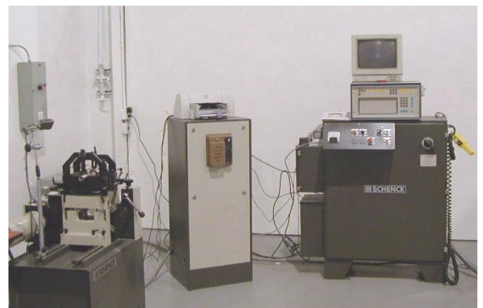
Centro de balanceo para componentes pequeños de hasta 45 kg (100 lb)
