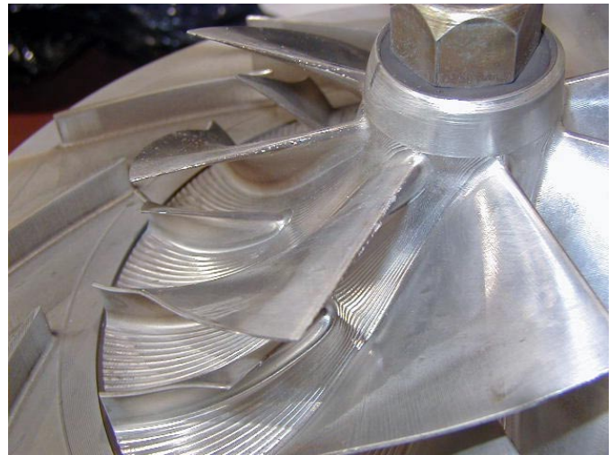
Impulsor de extremo de aire instalado y listo para el montaje final
