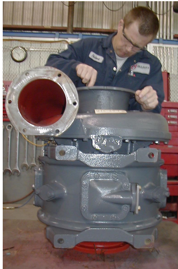
Revisiones y reparaciones completas de turboalimentadores
