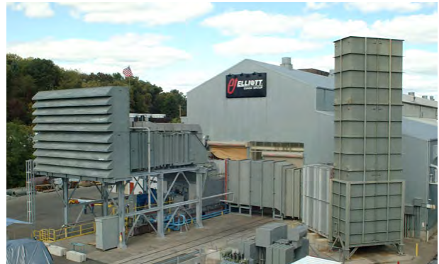
Full load LNG gas turbine/compressor test set-up.
